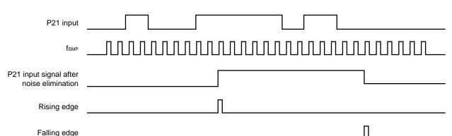
Figure 22-5. P21 Pin Edge Detection
